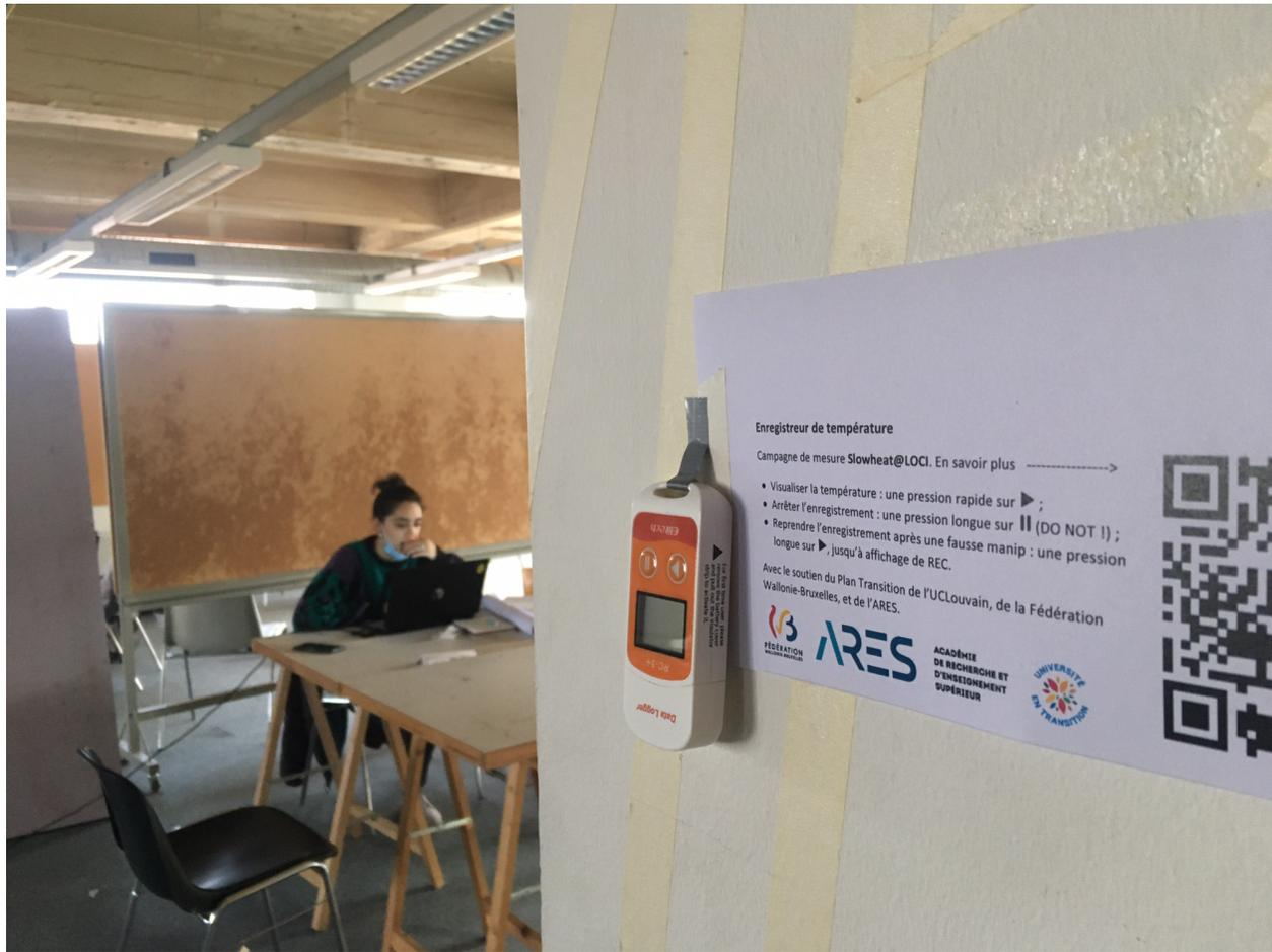
Figure 4 Exemple de mise en situation d'un enregistreur de température, ici dans un atelier d'architecture.
